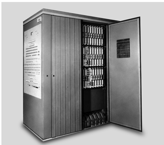
Рис. 2.5-15. Типовая конструкция шкафа ЭВМ М-10.
