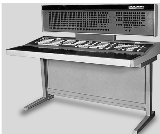
Рис. 2.7-1. Инженерный пульт управления ЭВМ «Алмаз».
